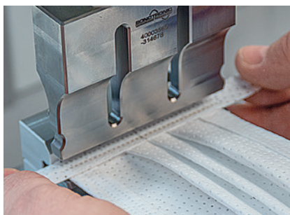
5. La soldadura vertical por ultrasonidos de las costuras laterales 3 y 4 fija las cintas planas de fieltro.
