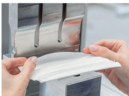
2. Pliegue manual del borde de fieltro antes de la soldadura por ultrasonidos.
