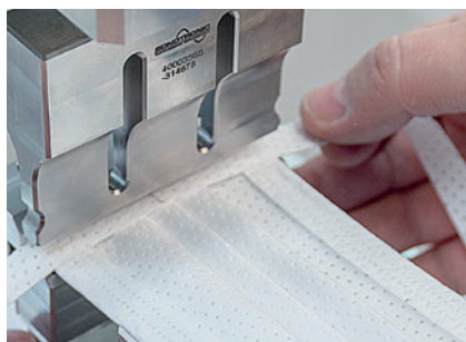
4. Colocar las cintas planas de fieltro para la fijación en la cabeza en el lado corto.
