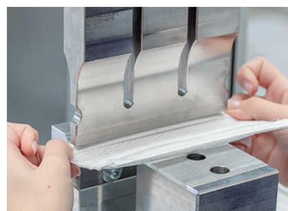
3. Soldadura horizontal por ultrasonido de las costuras transversales 1 y 2. La cinta de fijación de la nariz se coloca manualmente (sin imagen).
