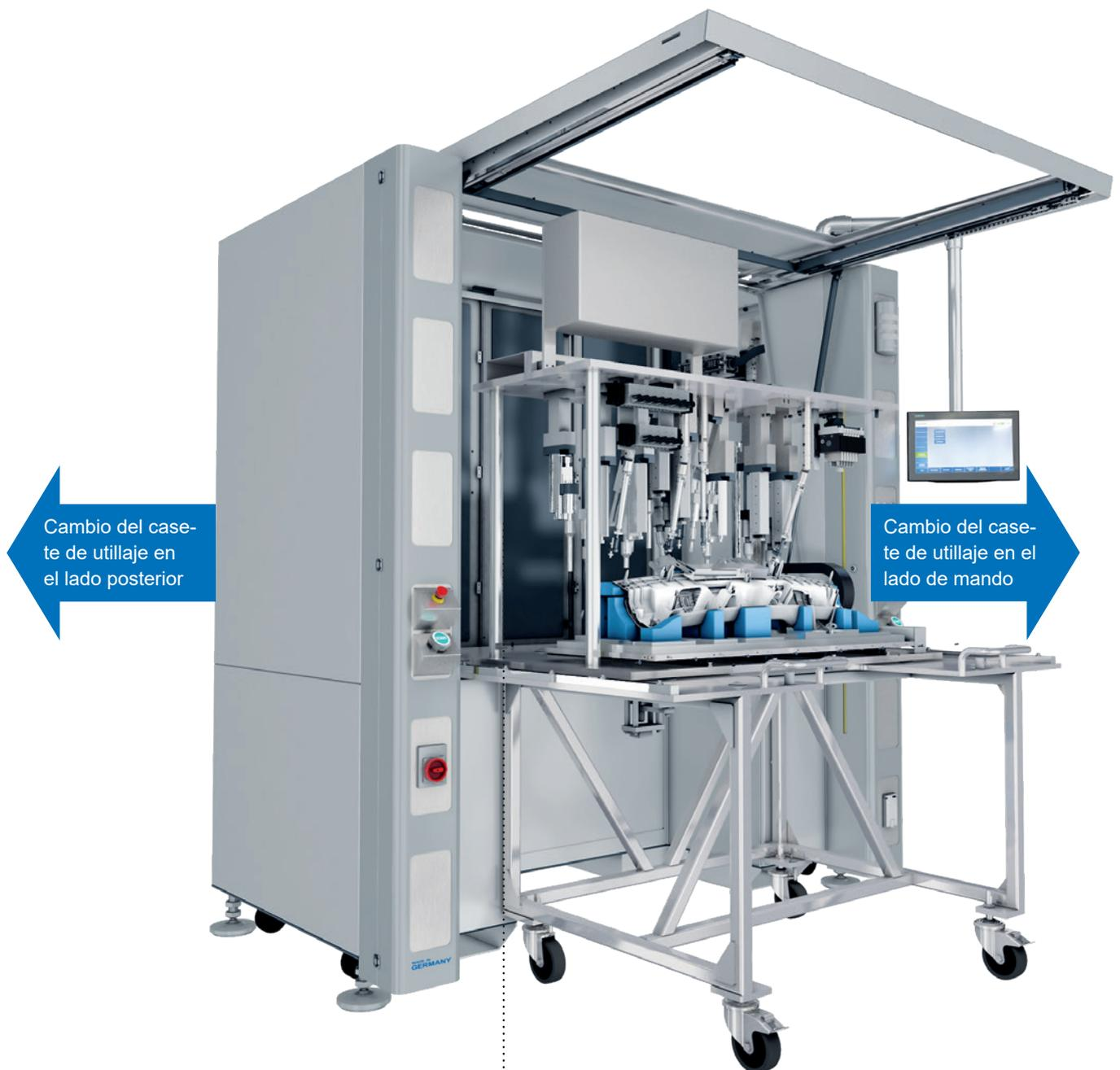
Cambio rápido de los útiles por formación del área de trabajo como casete de utillaje hacia adelante o hacia atrás
