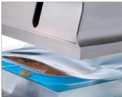
Siegeln einer produktbenetzten Schale
