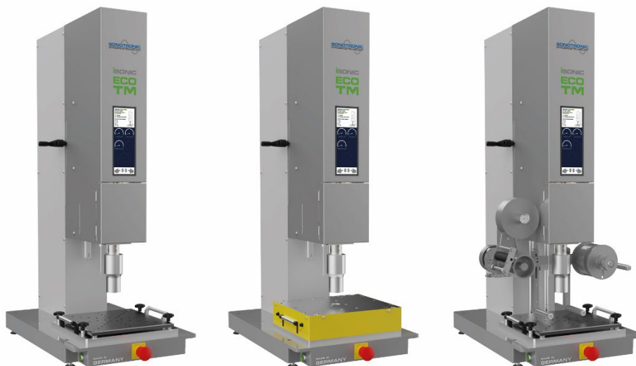
Bildunterschrift: von links: 1. iSONIC ECO TM Basic, 2. mit Schiebetisch zur ergonomischen Platzierung der Bauteile unter der Sonotrode, 3. mit Folienvorschubeinheit zum Schutz empfindlicher Bauteiloberflächen
