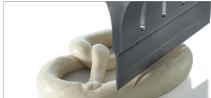
扭结面包的超声波切口
