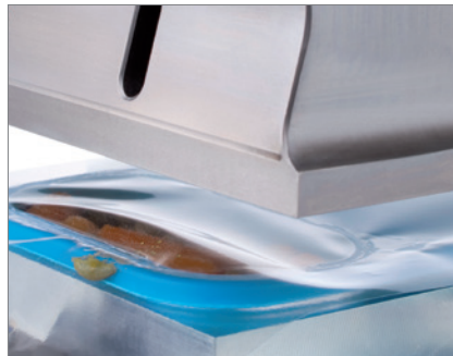
焊封被产品浸湿的托盘
