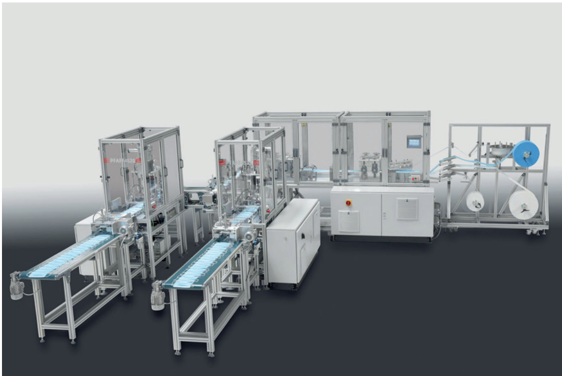
© Copyright SONOTRONIC Nagel GmbH Bildunterschrift: Die vollautomatische Maskenanlage PFAFF 4520
