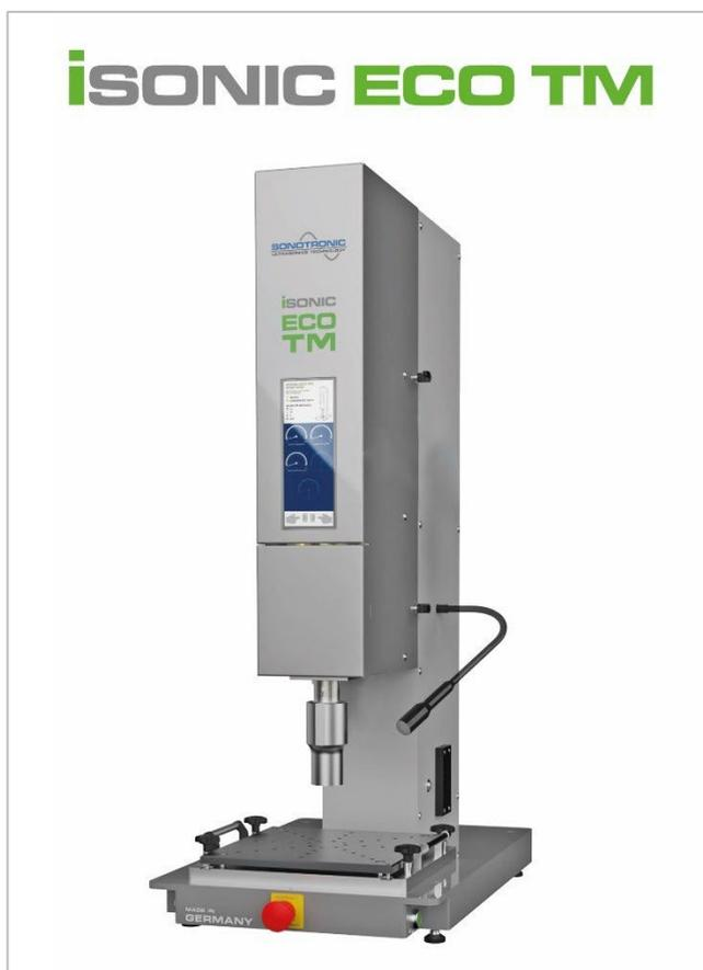
*Didascalie immagini: La macchina da banco ad ultrasuoni completamente elettrica funziona senza aria compressa, è esente da manutenzione e particolarmente efficiente dal punto di vista energetico. Con due frequenze integrate (20 kHz e 35 kHz) e un innovativo sistema di cambio rapido, copre un ampio spettro applicativo – dalla saldatura, all'impressione fino ai settori più esigenti come la tecnologia medica. Novità: un display da 9,3", opzionale anche touchscreen.*
