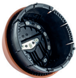
气囊盖的超声波铆接
