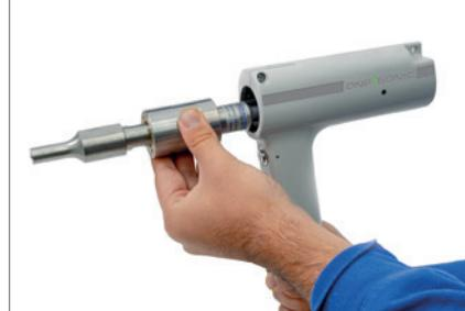
Einfacher und schneller Wechsel des Schwinggebildes möglich.
